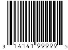
그림 4.2.4-1: GTIN-12 데이터를 인코딩한 UPC-A 바코드
