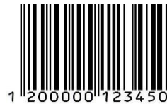
그림 4.1-2: GTIN-13 데이터가 인코딩된 EAN-13 바코드 (DI only)
