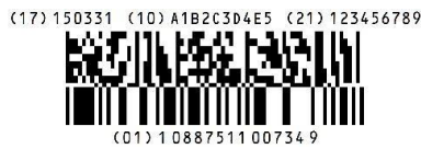
그림 4.3.2-4: GTIN-14, 유통기한, 제조번호 및 일련번호 데이터를 인코딩한 GS1 DataBar (Limited) & Composite Component 바코드
