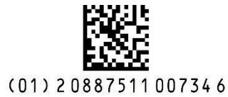
그림 4.2.4-3: GTIN-14 데이터를 인코딩한 GS1 데이터매트릭스 바코드
