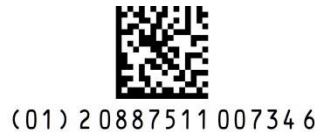
그림 4.1-4: GTIN-14 데이터가 인코딩된 GS1 데이터매트릭스 바코드(DI only 또는 DI + PI)
